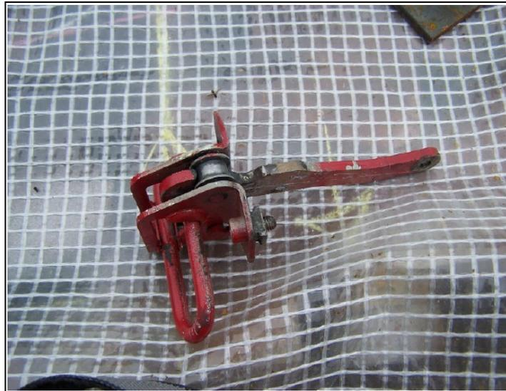
Cette pièce présente 2 positions. Une roulette à gorge libre peut se placer dans 2 crans possibles pour bloquer la porte en position ouverte ou fermée, un ressort de torsion (pièce en U) freine le mouvement. Le passage d'un cran à l'autre n'est pas possible manuellement pièce démontée.
