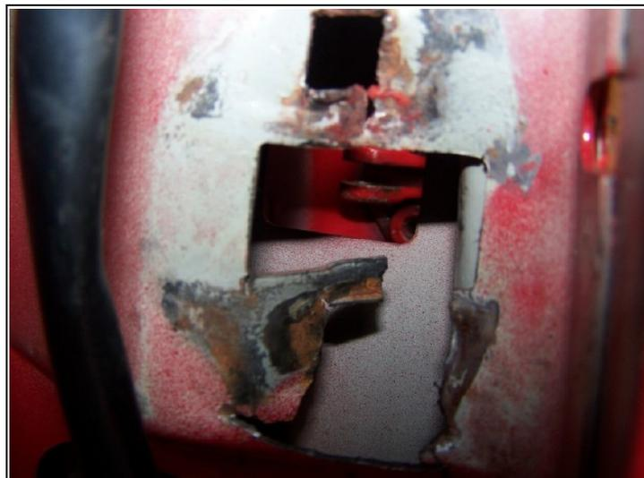
La méthode retenue pour réparer cet élément de carrosserie consiste à refabriquer une pièce d'ancrage, sous la forme d'un renfort qui sera soudé à plat à l'endroit ci-dessus.
