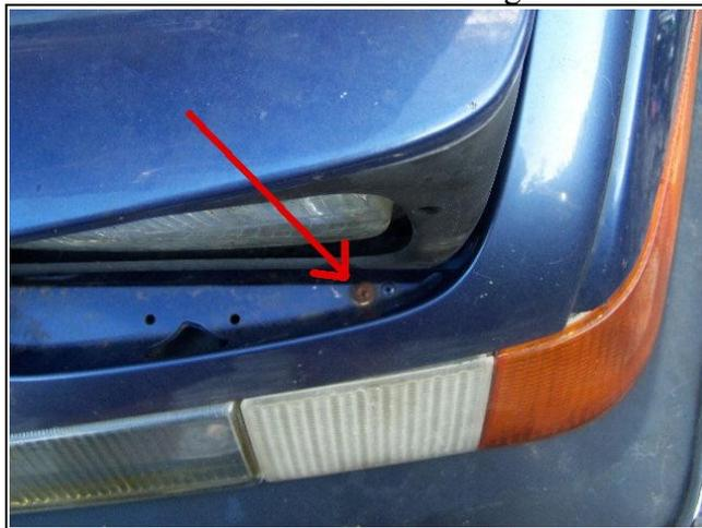
Tirer horizontalement vers vous le bloc de clignotants: il tient par un clips au bout du clignotant et 2 encoches devant.
