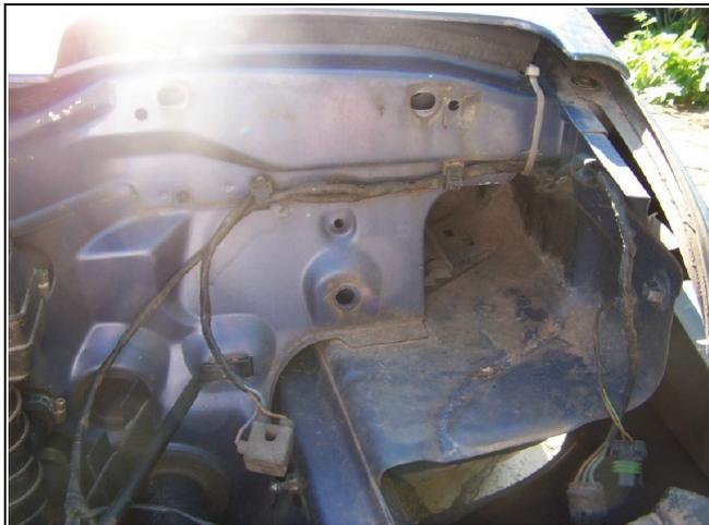
Penser à mettre du nettoyant contact dans les relais et au niveau du connecteur. Il n'est pas nécessaire de démonter quoi que ce soit: débrancher seulement ce connecteur et asperger de nettoyant contact.
