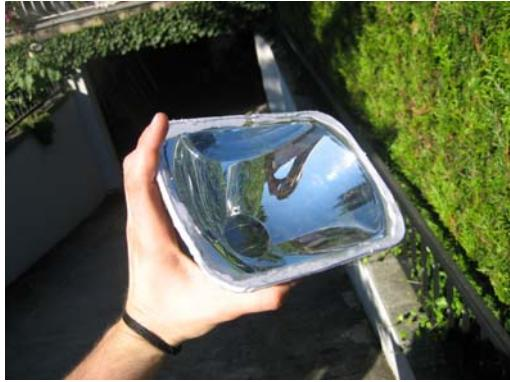
Tout d'abord, et après avoir démonté DELICATEMENT le verre du bloc optique d'origine, collez au silicone les « caches » en plexis sur le rebord du bloc.
