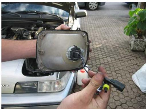
A le brancher avec l'ampoule comme une ampoule ordinaire.
