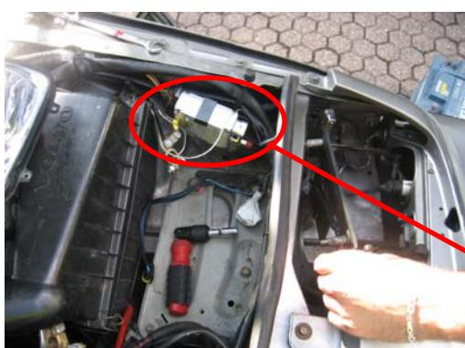
Démontez le porte bloc optique afin d'y faire passer le câble servant bien sur à l'alimenter le Xenon. Ce câble arrive du Ballast à Xenon que j'ai placé à coté de la batterie. Inutile de vous préciser l'importance de le faire passer correctement – Pop Up – il faut éviter tout enroulage de câble (je parle en connaissance de cause 1 Ballast grillé).
