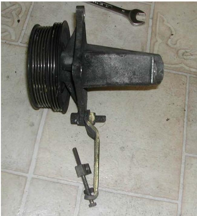
On récupère la pate de maintien de l'alternateur et on installe le compresseur en lieu est place, 4 BTR boulonnées
