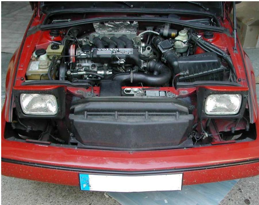
Le démontage du radiateur facilite grandement l'accès pour le montage du compresseur.
