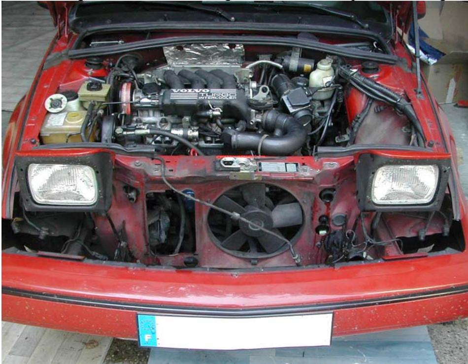
Ensuite, il faut désaccoupler la pompe DA et démonter l'alternateur. On trouve au dessous une poulie qui sera remplacé par le compresseur
