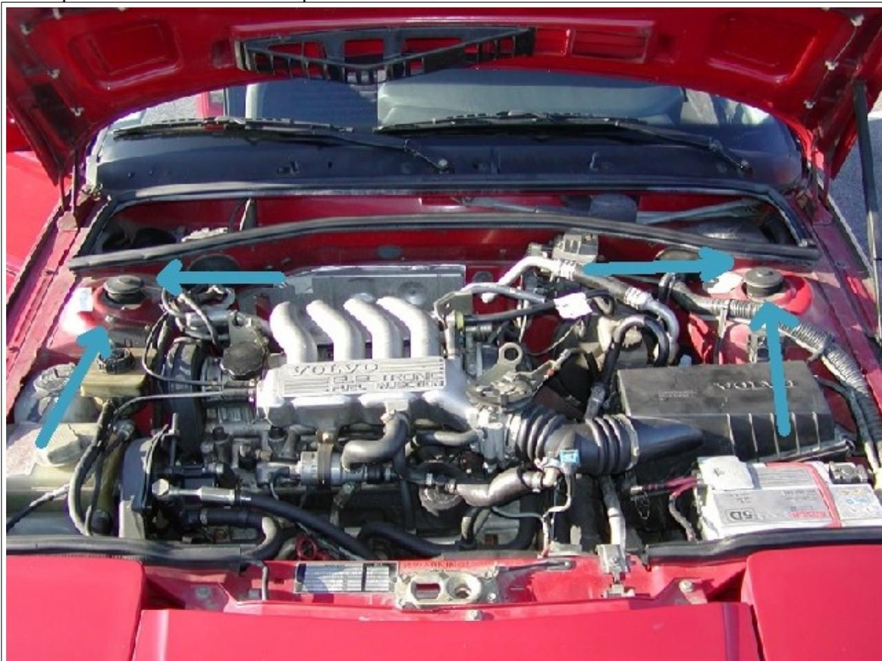
*Nb: ne pas desserrer l'écrou central du haut de l'amortisseur qui tient la jambe de force.*
