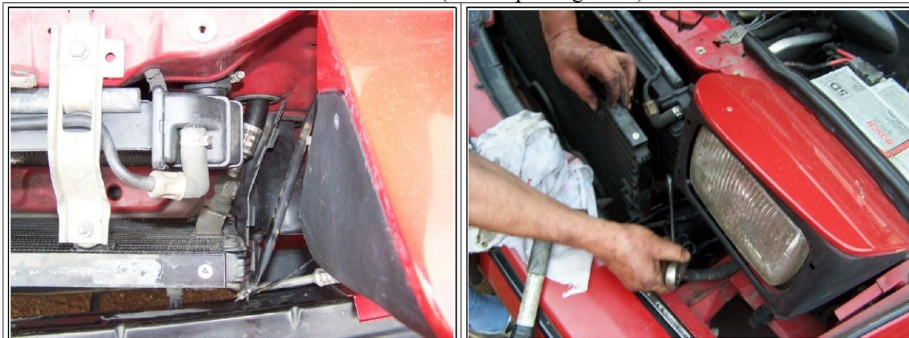
Démonter les vis de la patte de fixation du déshydrateur (récipient vertical derrière la boîte à air)
