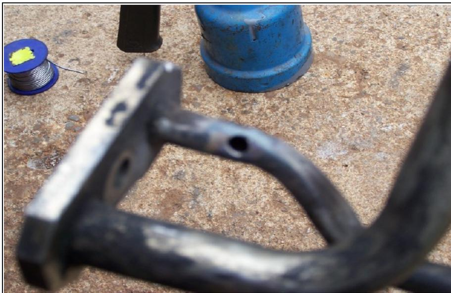
Le trou observé est bien net difficilement explicable par la corrosion. Le matériau constituant cette canalisation a gardé son aspect métallique et est magnétique. Il pourrait s'agir d'un cupronickel, ou d'un acier à forte teneur en cuir. Le matériau semble résistant à la corrosion généralisée, mais peut avoir connu une piqûre de corrosion.
