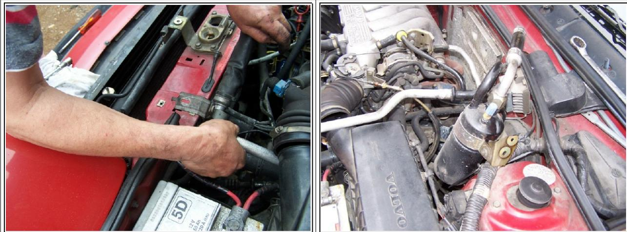
Les autres raccords entre les tuyaux de cette partie de la climatisation nécessite un outil spécial pour les déposer; pour une réparation ou un échange, il est plus simple de démonter l'ensemble:
