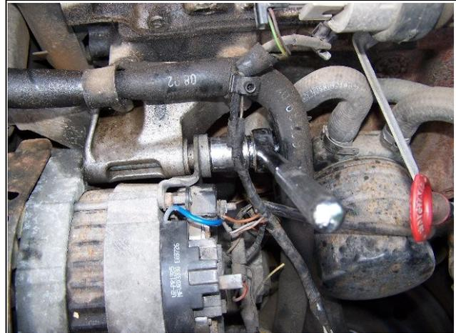
Il faut 2 clés 13, un clé de 17 et une de 15. La difficulté d'accès implique d'utiliser des clés à pipe ou un cliquet.
