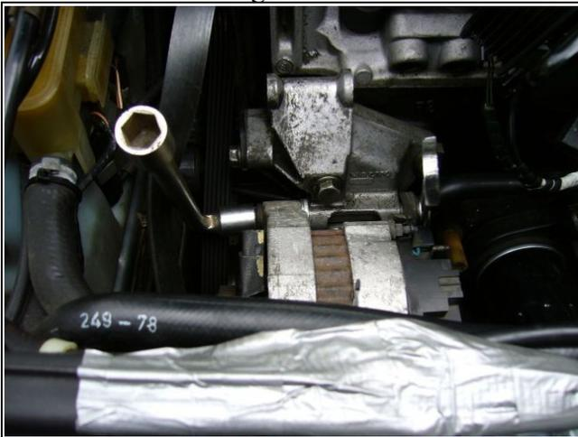
La courroie prend de plus en plus de mou, et peut être dégagée de la poulie de l'alternateur et de la pompe à eau.
